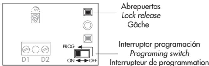
La programación de un teléfono debe realizarse desde la placa de calle principal del sistema. Recuerde que en sistemas con placa de calle con pulsadores, el grupo fónico de la placa de calle principal debe tener el puente J1 colocado. En sistemas con placa de calle con teclado, la placa debe estar configurada como placa principal (Consulte las instrucciones de la placa de calle).
